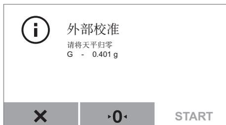
▷ 显示屏上会显示一条信息，提示您将校准砝码（50 g）放到水分仪上。
