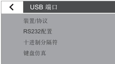
根据与水分仪相连的线缆和外围设备, 可在菜单中提供多个选项。水分仪会自动检测连接类型。
