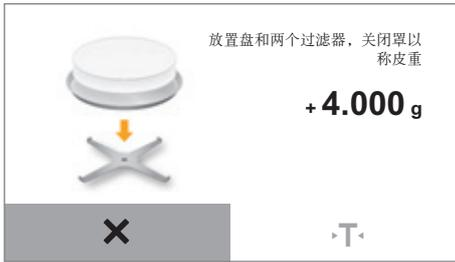
▶ 将空的样品盘放到水分仪上，并且可根据需要放上一个或两个过滤器。过滤器的数量取决于在当前方法的参数设定中设置了几个过滤器。
