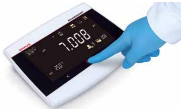
使用多功能触摸键盘，操作方便。您可能需要的重要信息都出现在6.5英寸的大显示屏，可选多种语言。三种读数模式，自动读数：具有稳定标识和可选的终点判断模式。连续读数：连续显示数值变化。定时读数：设定时间间隔自动读数。
