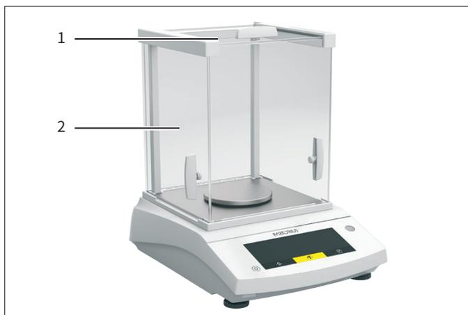
插图3: 带分析式防风罩的设备(示例)
