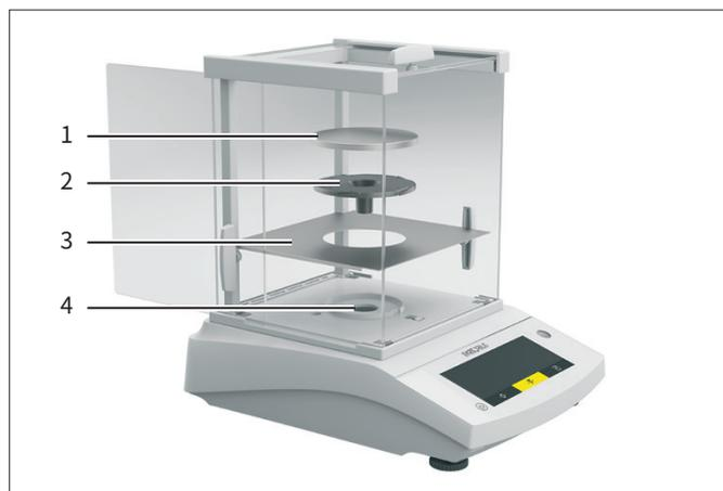
插图5: 带分析式防风罩的分析天平(示例)
